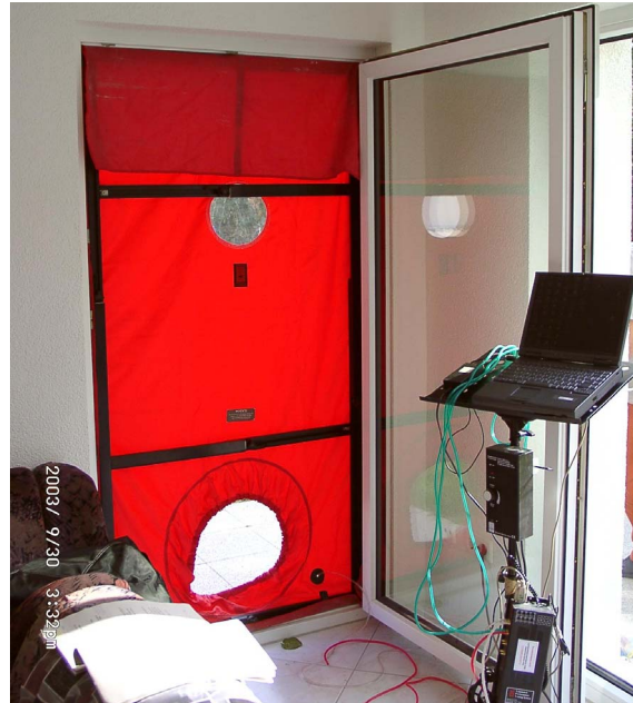
Abbildung 74: Gebläse und Rahmen sind jeweils in eine Terrassentür eingebaut (Objekt Rheinmünster / Bühl).
