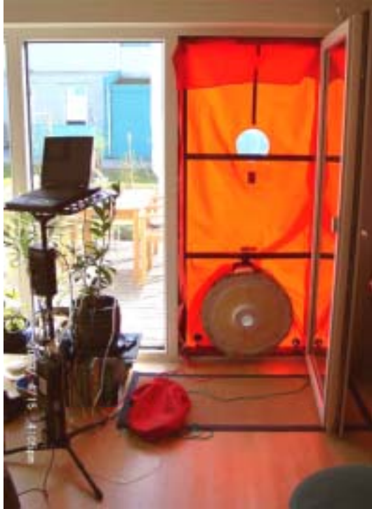
Abbildung 65: Messaufbau in einer Terrassentür bei einer der vier Nachmessungen in Hannover.
