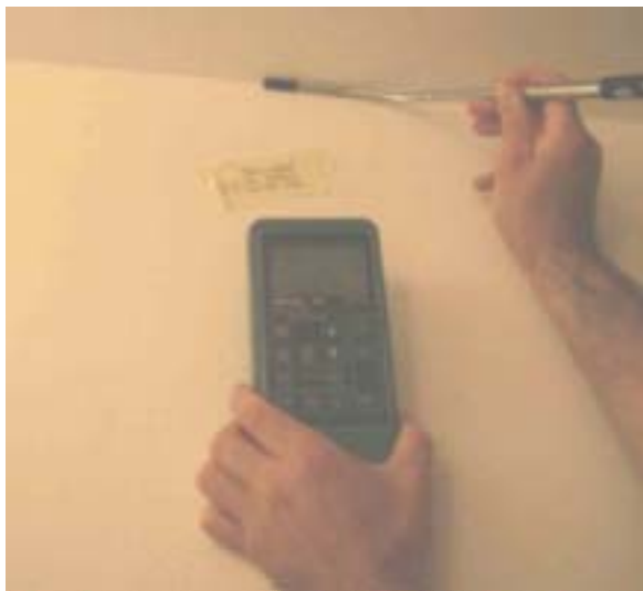
Abbildung 47: Restleckage am Dachanschluss aufgrund eines Ausführungsmangels des Dachdeckers.
