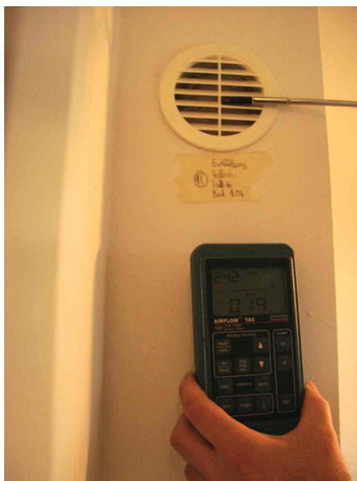
Abbildung 45: Restleckage Entlüftung des Toiletten-Fallrohrs (Entlüftungsventil ist im Schacht montiert).
