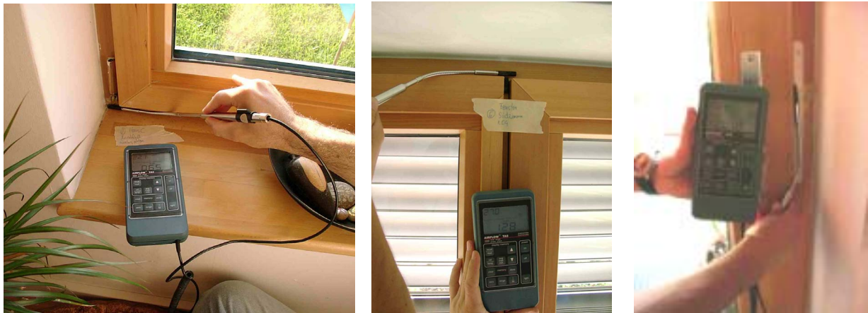
Abbildung 41: Restleckage an Fenster- bzw. Tüрдichtung. Doppelfenster mit Stulp sind oft ein Schwachpunkt.
