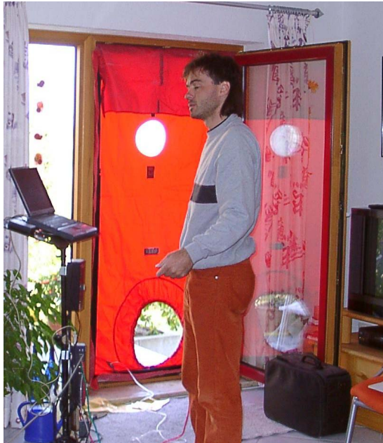
Abbildung 74: Gebläse und Rahmen sind jeweils in eine Terrassentür eingebaut (Objekt Rheinmünster / Bühl).
