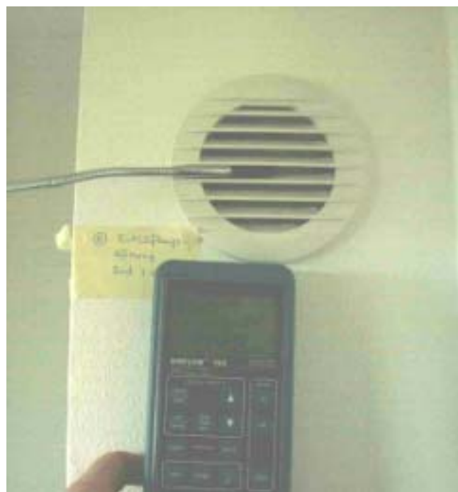
Abbildung 45: Restleckage Entlüftung des Toiletten-Fallrohrs (Entlüftungsventil ist im Schacht montiert).
