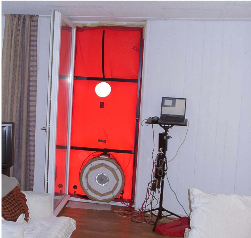
Abbildung 28: In Terrassentür eingebaute Blower Door (Haus 2).
