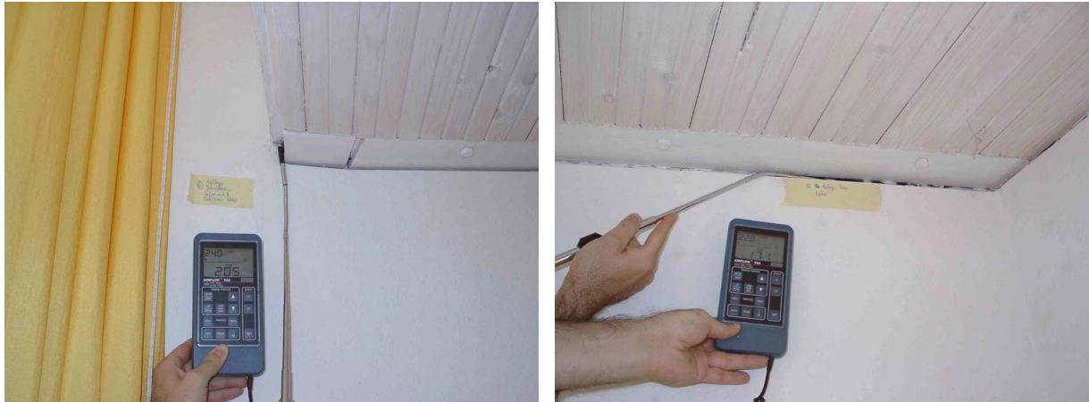
Abbildung 29: Leckage am Deckenaufleger.
