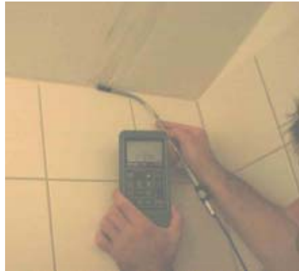
Abbildung 47: Restleckage am Dachanschluss aufgrund eines Ausführungsmangels des Dachdeckers.
