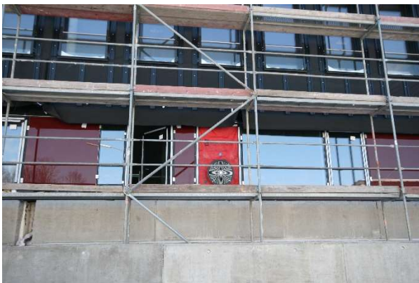
Abbildung 13: Durchführung der Blower Door Messung zur Feststellung der Gebäudeluftdichtheit am 13.03.2013. Links: Eingebauter Ventilator im EG (Nord-Ost Fassade). Rechts: Temporäre Abdichtung von Kabeldurchführungen. Diese wurden später dauerhaft verschlossen.
