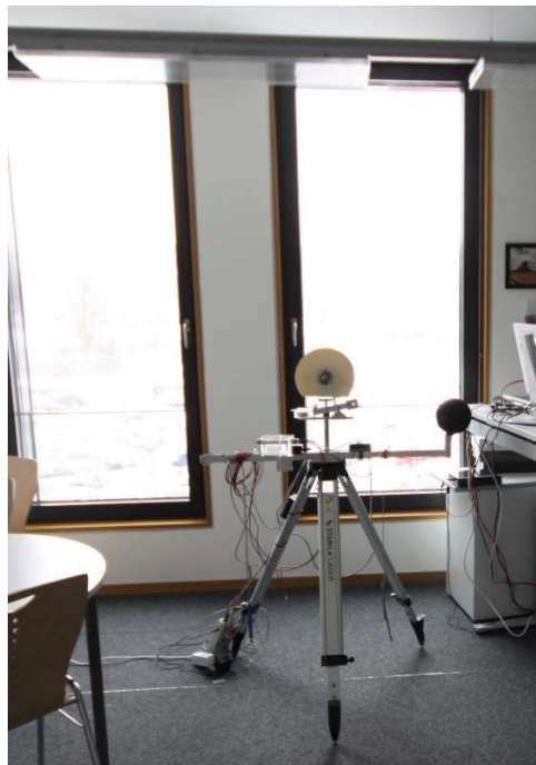
Abbildung 51: Messstativ mit Globethermometer, Psychrometer, Thermoanemometer, Temperaturfühler und Pygeometer während der Messung eines Büroraumes.
